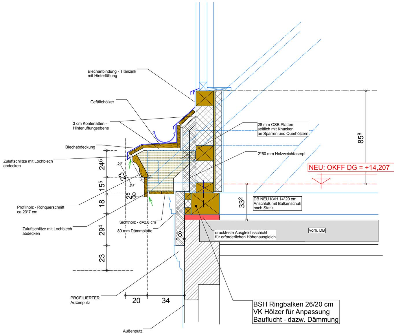
Blechanbindung - Titanzink mit Hinterlüftung
